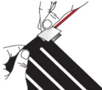
Analogamente, isolare anche i tagli nella parte terminale della stringa, come mostrato in foto, per impedire l'ossidazione della treccia sulla montante nel punto di taglio.
