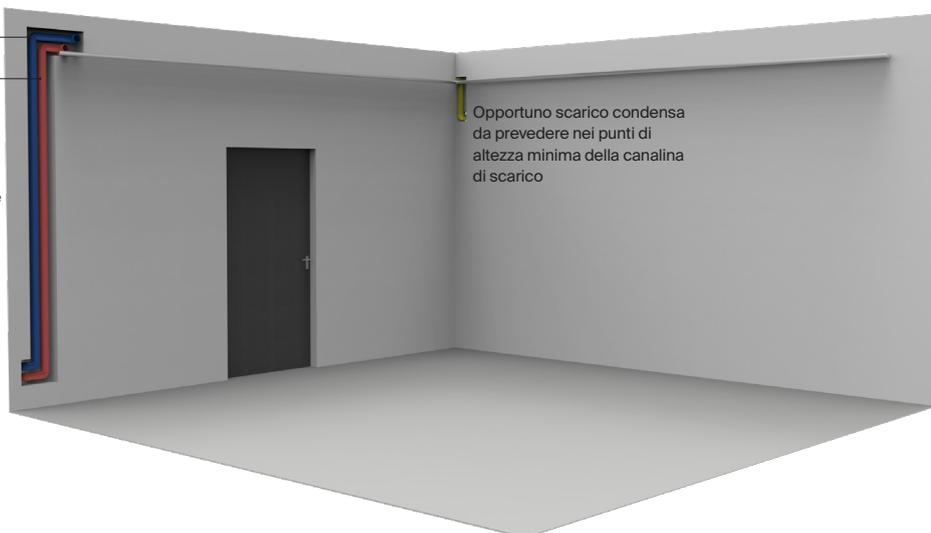
Opportuno scarico condensa da prevedere nei punti di altezza minima della canalina di scarico
