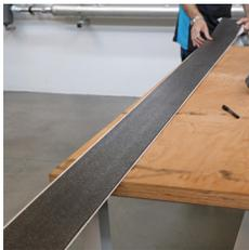
Applicare la fascia isolante perimetrale, codice 3754.00.02 sulla parte posteriore della dima, per tutta la lunghezza del profilo.
