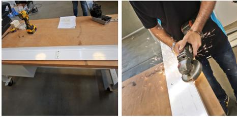
Fissaggio dei supporti a muro alla dima tramite viti autofilettanti  $\text{\O}5 \times 10$  mm svasate.
